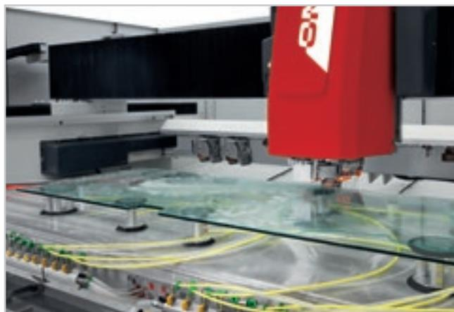
Usinage complet d'une porte : fraisage et meulage d'entaille, meulage et polissage périphérique.
